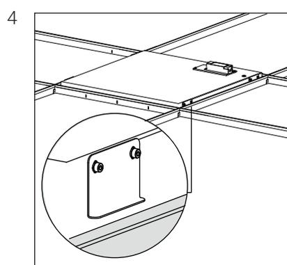
С помощью регулировочных винтов, выставить световой модуль в уровень с панелями Focus Ds.
